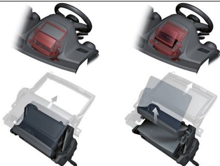
Questi HUD richiedono molto meno spazio di montaggio, ma risultano meno efficaci nel favorire l'occhio. Foto: Citroen
