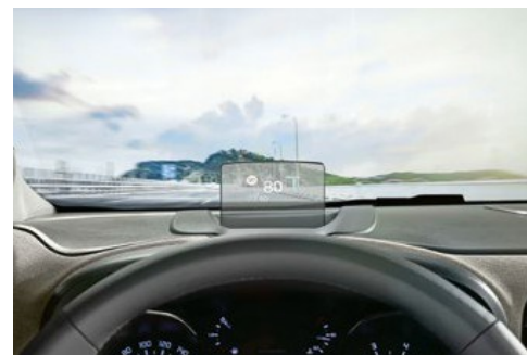
Questi HUD richiedono molto meno spazio di montaggio, ma risultano meno efficaci nel favorire l'occhio. Foto: Citroen
