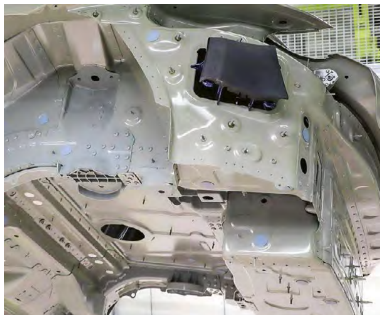
In futuro, le lamiere della carrozzeria, i profili estrusi e i pezzi fusi potranno essere combinati con pezzi di carrozzeria prodotti attraverso la produzione additiva, permettendo così di ottenere una resistenza e una massa ottimali. Foto: Porsche
