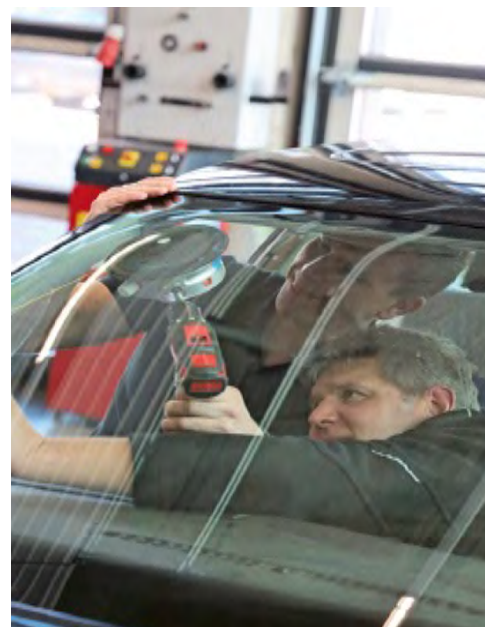
I partecipanti al corso possono, lavorando in gruppo, tagliare da soli un parabrezza.
