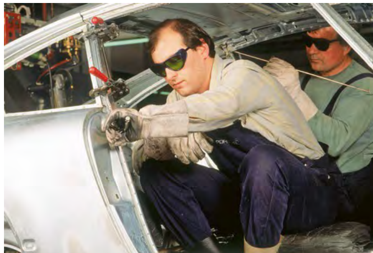
Carrozzeria grezza di un tempo: le lamiere della carrozzeria di una Porsche 911 venivano assemblate mediante saldatura a punti. Una grande parte di lavoro manuale comporta alti costi di produzione. Foto: Porsche
