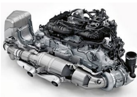
Ciò che colpisce del nuovo motore 6 cilindri boxer della GTS è che ora ha un solo turbocompressore dei gas di scarico sul lato destro del veicolo (anziché due come su tutte le altre varianti). Non solo viene utilizzata una macchina elettrica tra il motore a combustione e il cambio a doppia frizione a otto rapporti, ma anche, per la prima volta, un turbocompressore a gas di scarico con azionamento/recupero elettrico. Foto: Porsche
