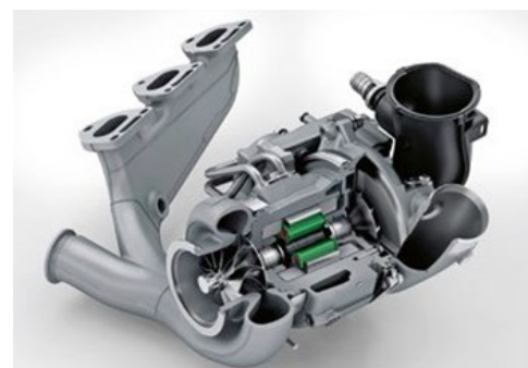
Proprio come in Formula 1: un rotore azionato elettricamente o un rotore progettato come sistema di recupero alimenta tutti i cilindri con aria precompressa grazie a una turbina e a una ruota compressore il cui diametro non è più di 50 ma di 80 mm. Invece di far passare i gas di scarico attraverso una valvola di bypass al limite della pressione di sovralimentazione, la ruota della turbina può azionare la macchina elettrica che funge quindi da generatore di elettricità. Foto: Porsche
